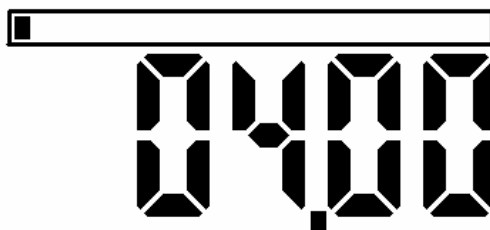
图12 4mA时表头显示值设定LCD显示界面
