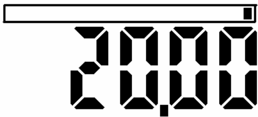
图13 20mA时表头显示值设定LCD显示界面
