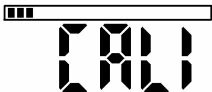
图9 读取满量程AD值时LCD显示界面
